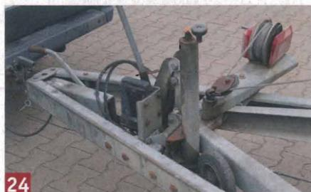
24 Abschlusskontrolle an der Deichsel. Alles ist angeschlossen und das Stützrad ist oben.
