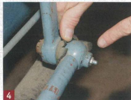
**4** Die Gummimanschetten der Kugelkopflager sind alle rissig. Sie müssen getauscht werden.
