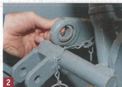
2 Das Augenlager am Hydraulikhebel ist ohne fühlbares Spiel. Der Lacksprühnebel muss jedoch entfernt werden.
