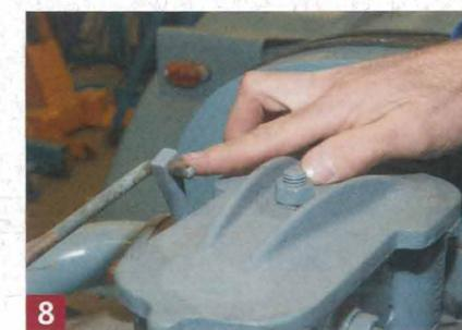
**8** An allen Verbindungen und Gelenken des Gasgestänges fehlen die Sicherungssplinte und Kleinteile.
