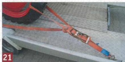
21 Die hinteren Zurrgurte werden nach hinten abgespannt, um den Bremskräften entgegen zu wirken.
