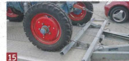
Die vorderen Räder müssen an der verstellbaren Pufferschiene zum Stehen kommen.
