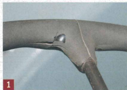
**1** Das Lenkrad zeigt deutliche Risse und einen UV-Schaden. Es muss aus Sicherheitsgründen gewechselt werden.
