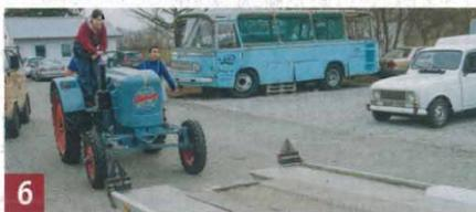
Der Traktor steht richtig, wenn die Räder mittig zu den jeweiligen Fahrbahnschienen ausgerichtet sind.
