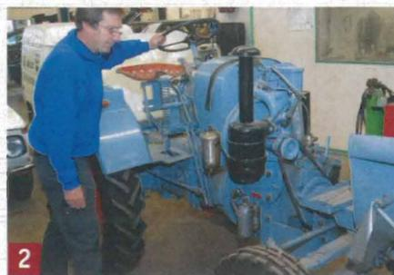
**2** Zum Testen des Lenkradspiels dreht Robert am Lenkrad und beobachtet die vorderen Räder.
