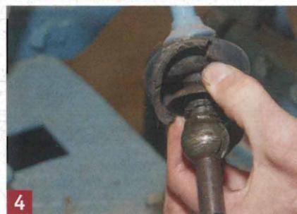
4 Beim Versuch, das Getriebe durchzuschalten, hält Robert den Hebel in der Hand. Der Sicherungsring fehlt.
