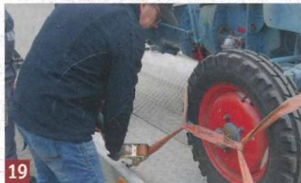
19 Zum festen Spannen sind gute Zurrgurte mit einer starken Ratsche ausgerüstet.
