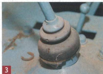
3 Die Gummiabdeckung des Schalthebels ist rissig. So kann Wasser in die empfindliche Schaltkulisse eindringen.
