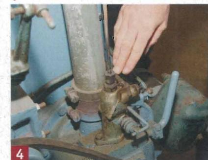
**4** Die Diesel-Einspritzpumpe für den Einzylinder-Motor ist dicht. Trotzdem sollte sie gespült werden.
