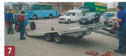
Einige Anhänger lassen sich zum einfacheren Beladen durch eine Hydraulik nach hinten absenken.
