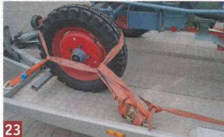
23 Die langen Enden der Zurrgurte müssen gegen Flattern im Fahrtwind gesichert werden.
