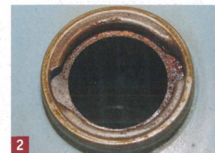
**2** Der Diesel im Tank muss abgelassen werden, um Rost und Wasser vollständig entfernen zu können.
