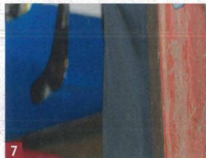
**7** Öffnungsversuch? An der unteren Achsbolzen-Verschraubung fehlen die Mutter und der Sicherungssplint.
