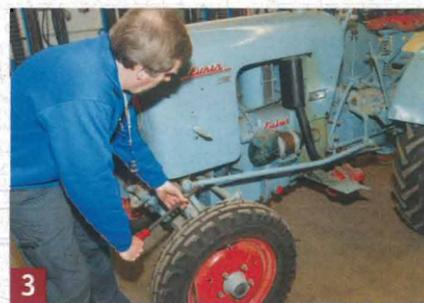
**3** Zum Testen des Lenkgestängespiels der Kugelkopflager verwendet Robert eine Brechstange.
