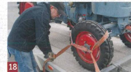
Die Schleifen der Gurte werden über die Reifen gelegt, um sie nach unten zu ziehen.
