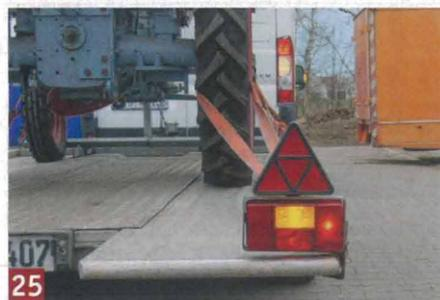
25 Beleuchtungsscheck! Gehen Blinker, Brems- und Fahrtlicht und die anderen Signale?
