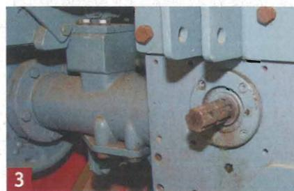
3 Der Verschleiß an der Abtriebswelle am Heck des Eichers ist gering. Sie hat nur wenige Arbeitsstunden hinter sich.
