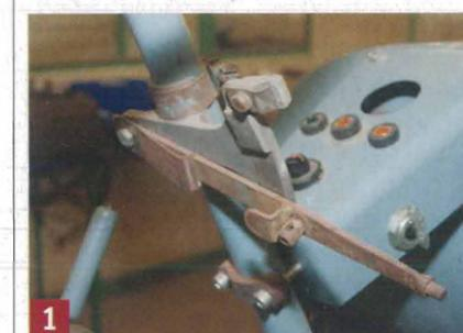
1 Am Feststellhebel für das Gas fehlen sämtliche Anbauteile. Vielleicht liegen sie in der Teilekiste?
