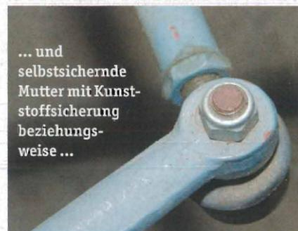
... und selbstsichernde Mutter mit Kunststoff-sicherung beziehungsweise ...
