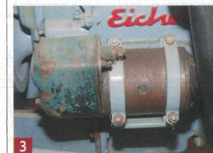
3 Der Elektrostarter ist zwar technisch in Ordnung. Er kann aber nicht funktionieren. Sämtliche Kabel fehlen.
