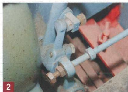
2 Das Kupplungsgestänge ist nicht richtig eingestellt. Die Sicherungsmutter ist nur lose aufgedreht.
