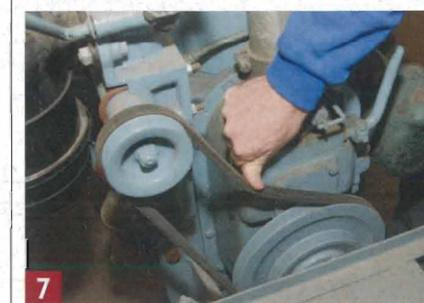
**7** Der Keilriemen für den Lüfterantrieb ist zu wenig gespannt und zeigt feine Risse. Er muss gewechselt werden.
