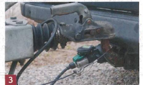
3 Die Deichsel-Kupplung sitzt auf dem Kugelkopf, die Elektrik ist angeschlossen und das Fangseil ist eingehängt.
