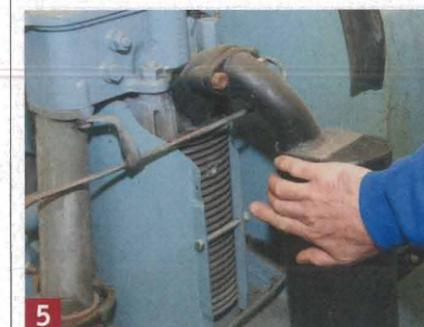
**5** Die Dichtungen am Motor sind dicht. Auch die Lüftungsbleche der Motorkühlung sind sauber.
