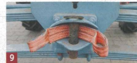
Das Nylonband mit zwei Schlaufenenden wird um den Steckbolzen der Frontkupplung gezogen.
