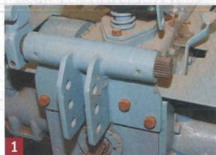
1 Der rechte Hebelarm (in Fahrtrichtung gesehen), an dem die Ackerschiene montiert wird, ist nicht mehr vorhanden.
