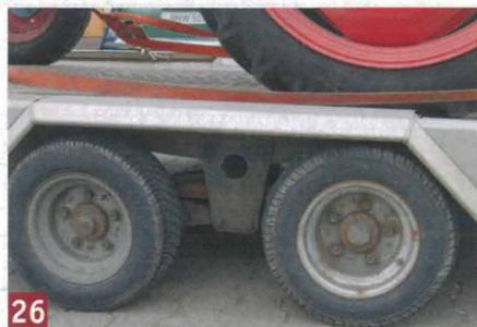
26 Der Luftdruck der Reifen sollte vor der Fahrt bei beladenem Hänger geprüft werden.
